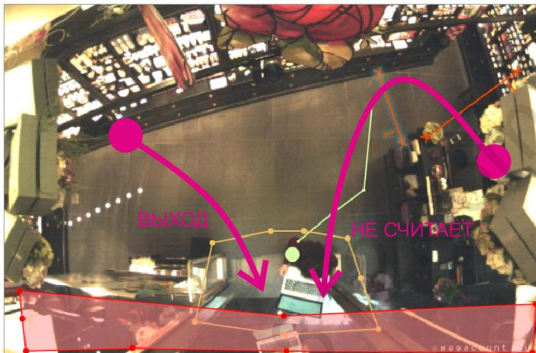
Пример применения линий исключения: слева, в заранее обговоренном с персоналом месте проводится линия исключения - при входе и выходе персонал должен пройти оговоренные области на входе и выходе и пересечь линию исключения.
