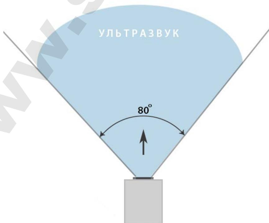
**ВНИМАНИЕ!** Обращаем ваше внимание на то, что неслышимое ультразвуковое воздействие на микрофоны диктофонов и мобильных телефонов не может гарантировать 100% блокировку аудиозаписи. Это напрямую зависит от чувствительности и мембраны микрофона записывающего устройства, а так же его расположения.
