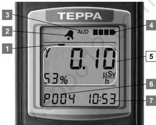
Рисунок 30 – ЖКИ дозиметра (просмотр результатов измерений)
