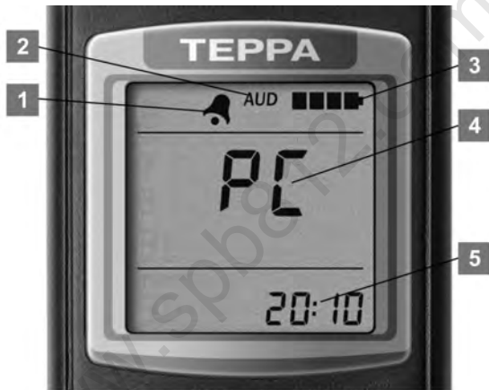
Рисунок 27 – ЖКИ дозиметра (режим управления информационным обменом с ПК)
