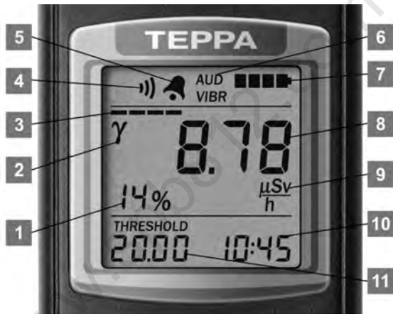
Рисунок 3 – ЖКИ дозиметра (режим измерения МЭД фотонного ионизирующего излучения)
