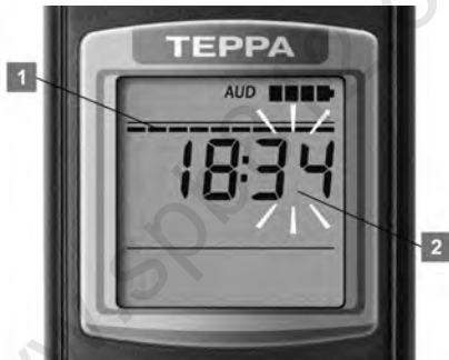
Рисунок 22 – ЖКИ дозиметра (подрежим коррекции времени и даты – программирование времени)
