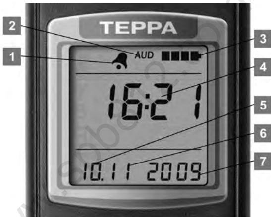
Рисунок 21 – ЖКИ дозиметра (режим часов)
