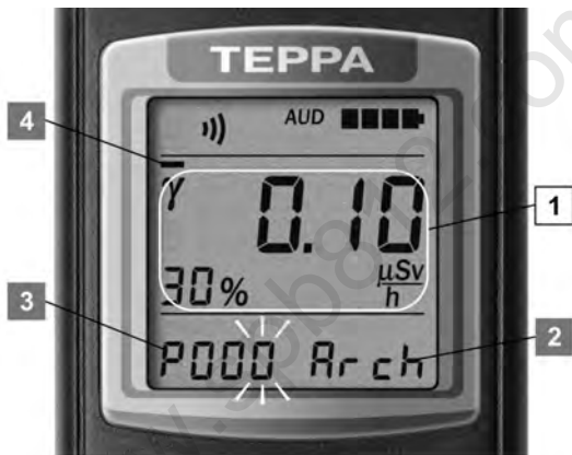
Рисунок 10 – ЖКИ дозиметра (подрежим сохранения результата измерения МЭД фотонного ионизирующего излучения)
