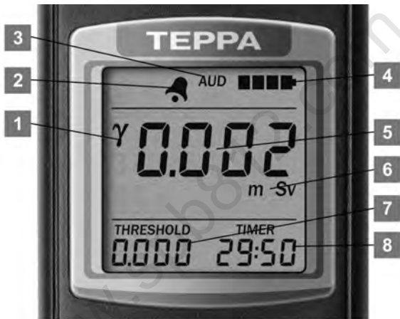
Рисунок 11 – ЖКИ дозиметра (режим отображения накопленного значения ЭД фотонного ионизирующего излучения)
