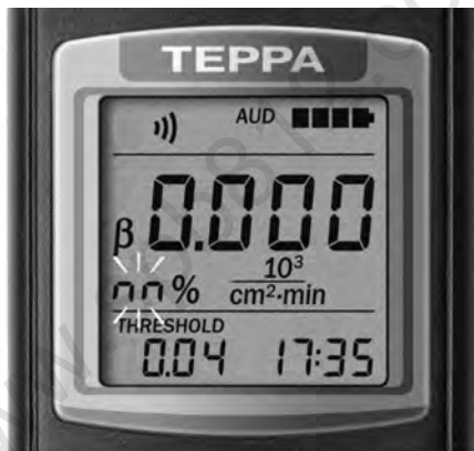
Рисунок 17 – ЖКИ дозиметра (перезапуск измерения)
