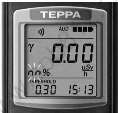
Рисунок 6 – ЖКИ дозиметра (перезапуск измерения)
