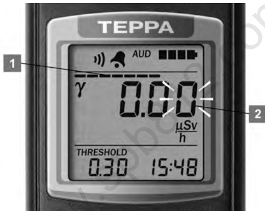
Рисунок 7 – ЖКИ дозиметра (подрежим программирования порогового уровня срабатывания сигнализации)
