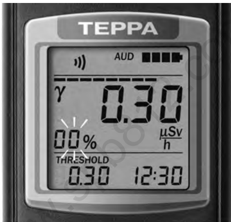
Рисунок 8 – ЖКИ дозиметра (подрежим программирования порогового уровня срабатывания сигнализации)
