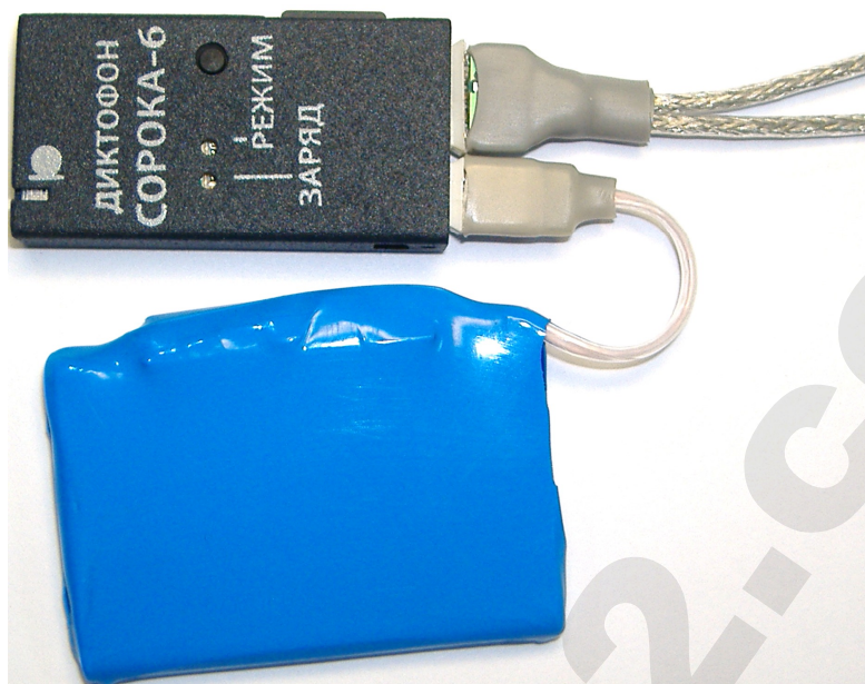
Рис. 9. Пример работы диктофона «СОРОКА-06» с внешним аккумулятором и внешними стерео микрофонами.
