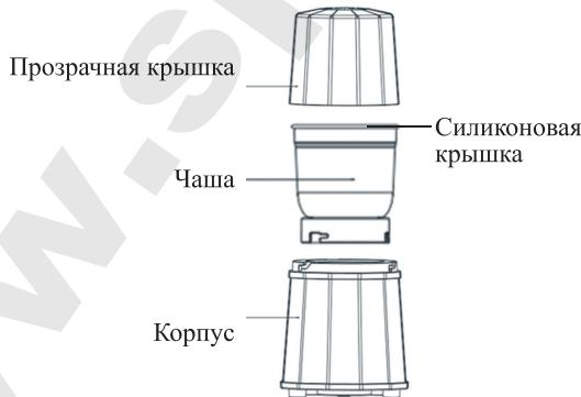
На чашу надевается силиконовая крышка. На корпус кофемолки устанавливается чаша и фиксируется до упора поворотом по часовой стрелке. Затем на кофемолку надевается прозрачная крышка и фиксируется поворотом по часовой стрелке до фиксации.
