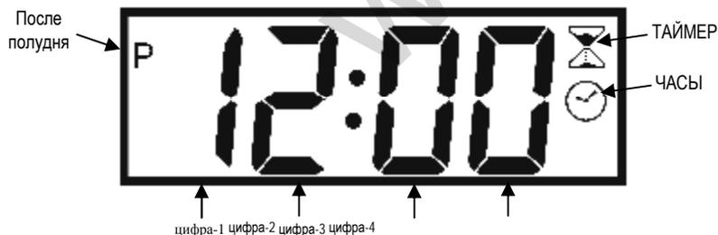
текущих минут. Затем нажмите кнопку **SET** для подтверждения. Чтобы выбрать между 12 и 24-часовым режимом часов, нажмите **CLOCK**. Для завершения установки часов нажмите **START**. Если в течение 90 сек. Вы не установите текущее время, на дисплее появятся цифры «1 07» . Чтобы опять вернуться в режим первоначальной настройки часов – выключите питание и включите кормушку опять, выждав 1 минуту.
