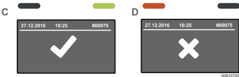
**C)** Alkohol ni odkrit. Test je uspešen. Zasveti tudi zelena LED. Po 2 sek. bo instrument znova pripravljen na uporabo.
