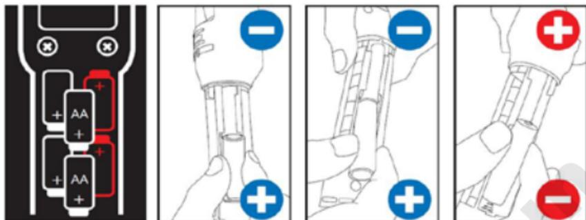
Совместите крышку батарейного отсека и прибор (стрелка вверх), выровняйте выступ с прорезью на приборе и затяните винт по часовой стрелке монетой или соответствующим инструментом.
