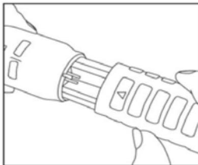
Вставьте или замените шесть щелочных батарей 1.5 В типа AA или перезаряжаемых батарей. Пожалуйста, убедитесь, что батарейки установлены правильно (следуйте схеме установки батарей).
