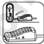
2. Подсоедините синий штекер силовых зажимов к устройству до упора и убедитесь, что индикаторы подключения (на блоке силовых зажимов) не горят.
