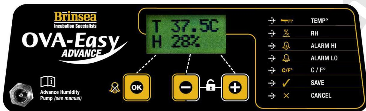
Система управления инкубатора Ova-Easy Advance использует высокоточные датчики температуры и влажности, подверженные индивидуальной калибровке. Будьте осторожны, используя дешевые аналоговые или цифровые термометры и гигрометры, при сравнении их показаний с показаниями дисплея хетчера.
