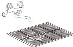
Рекомендуется промывать фильтр раз в 2-3 недели под проточной холодной водой, предварительно промыв его мыльным раствором. После чистки тщательно просушить перед установкой в устройство.
