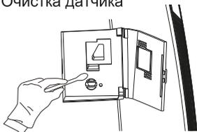
Период очистки раз в 1-2 месяца. Когда датчик загрязняется пылью и прочими частицами. Используйте ватный тампон, чтобы стереть пыль, иначе чувствительность снизится.
