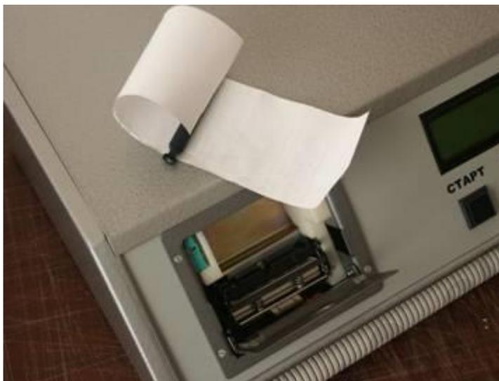
Рисунок 3б -Внешний вид встроенного принтера без валика
