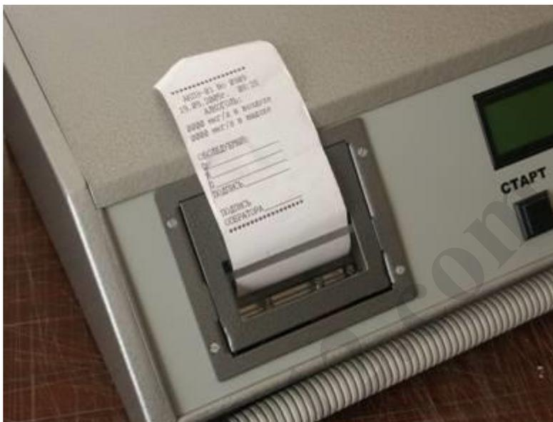
Рисунок 3г - Внешний вид встроенного принтера с заправленной бумагой
