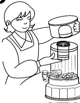
Закрепите фильтр-картридж на соединительном кольце, а керамический фильтр - в емкости для водопроводной воды
