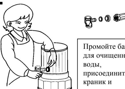
Промойте бак для очищенной воды, присоедините краник и магнитную трубку
