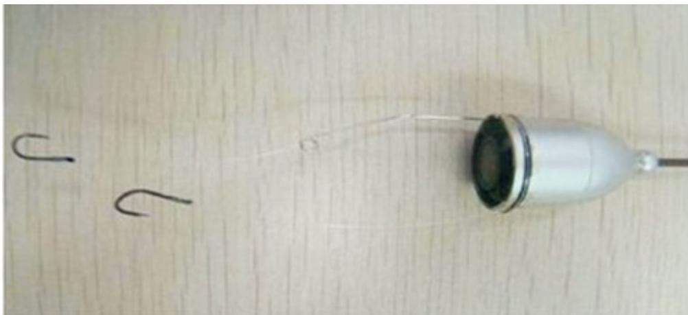
**Примечание:** не крепите леску с рыболовным крючком непосредственно на кабель камеры. Это может повредить кабель. Крепите леску в специальную канавку на нижней части корпуса камеры.
