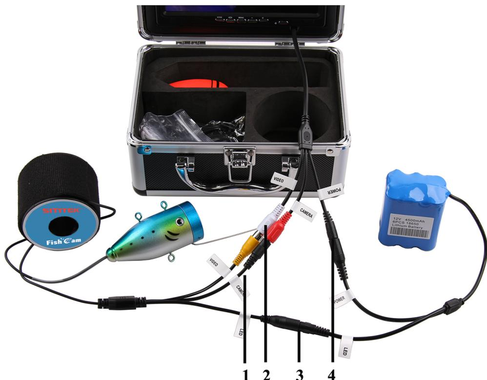
Возле каждого штекера на кабеле имеются наклейки – этикетки с разными маркировками: CAMERA (1) , VIDEO (2) , LED (3) и POWER (4) . Подключите эти штекеры к соответствующим маркировкам: CAMERA + CAMERA, VIDEO + VIDEO, LED+ LED, POWER + POWER. Каждый штекер имеет свою расцветку. Смотрите фотографии, как показано выше.
