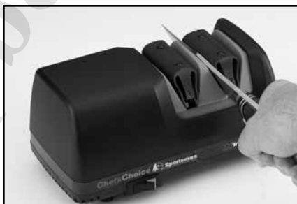
Рисунок 6. Установка лезвия в левый паз Этапа 2. Поочередные проходы лезвием в левом и правом пазах.
