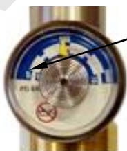
Рисунок 23 – Манометр на редукторе баллона
