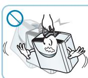
Перед тем, как переносить воздухоочиститель, слейте воду из бака; переносите воздухоочиститель, держа его за ручку, чтобы не наклонять во время переноски.
