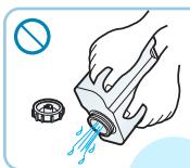
Если возможна температура ниже нуля, слейте воду из водяного бака и резервуара, чтобы она не замерзла.
