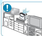
Не устанавливайте воздухоочиститель на электронную радиоаппаратуру, такую, как телевизор, а также на нагревательные приборы.
