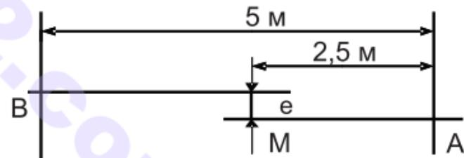
Повернуть лазерный построитель так, чтобы сместить луч приблизительно на 2,5м влево и проверить, чтобы горизонтальная линия находилась в пределах значения „точность” (см. характеристики) на той же высоте, что и нанесенная отметка, указанная лазерным крестом. Повторить эти же действия , смещая лазерный инструмент вправо. Внимание: ось вращения при проверке точности не смешайте.
