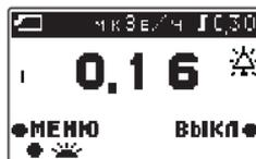
\* Короткий цикл наблюдения равен половине полного цикла. и предназначен для быстрого получения предварительных результатов. Первый достоверный результат после включения изделия выводится на дисплей через 1 - 26 сек в зависимости от МЭД и отображается пиктограммой «
