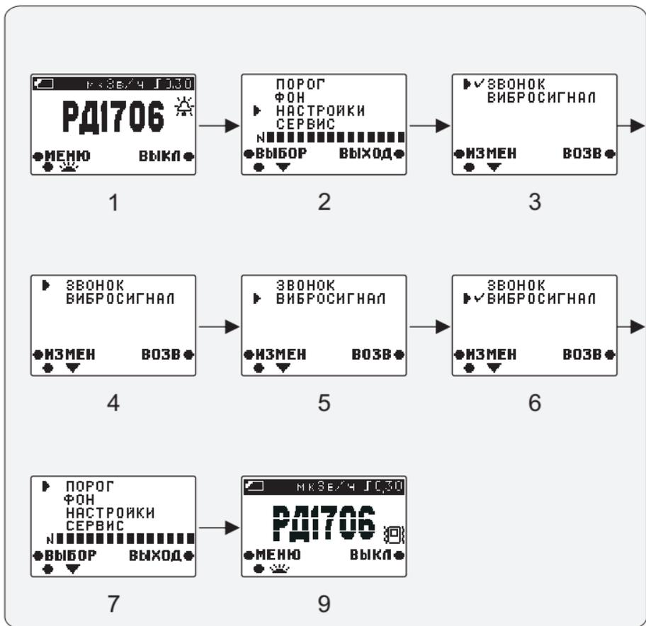
Теперь, если значение мощности дозы превысит установленный порог сигнализации (при включенном пороге - см. стр. 19), то включится вибросигнал. Вибросигнал будет работать в импульсном режиме до конца цикла оценки.
