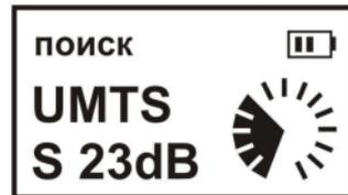
На дисплее отображается сигнал, имеющий максимальный уровень. Аудиоконтроль в режиме поиска возможен только для аналоговых сигналов. Для аудиоконтроля текущего сигнала нажмите кнопку **[ОК]** (см. раздел «Аудиоконтроль»).
