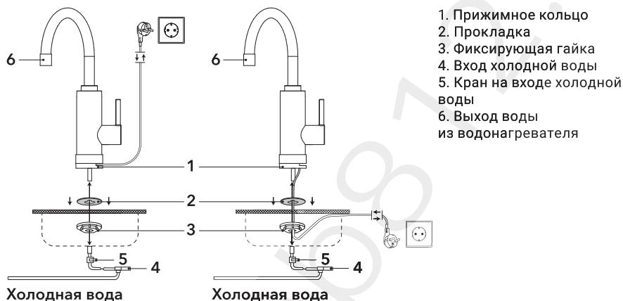
Проточный водонагреватель следует подключать к водопроводной сети с давлением воды от 0.4 до 6 бар. Прибор можно снабжать водой из резервуара, уровень воды в котором должен быть не менее, чем на 4 метра выше уровня водонагревателя.
