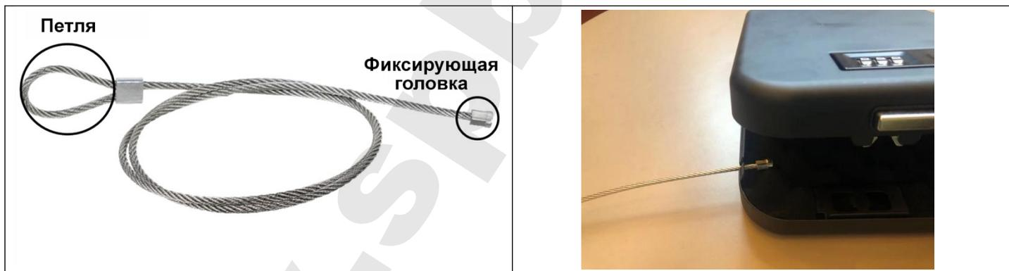
Стальной крепёжный тросик имеет диаметр 4 мм, его предел прочности – 1500 кг. Основной функцией тросика является фиксация сейфа для предотвращения его кражи.
