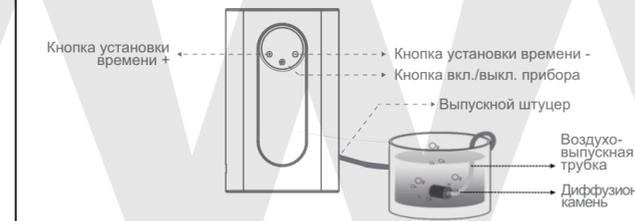
Устройство включает в себя: корпус, воздуховыпускную трубку, 2 диффузионных камня и инструкцию по эксплуатации.
