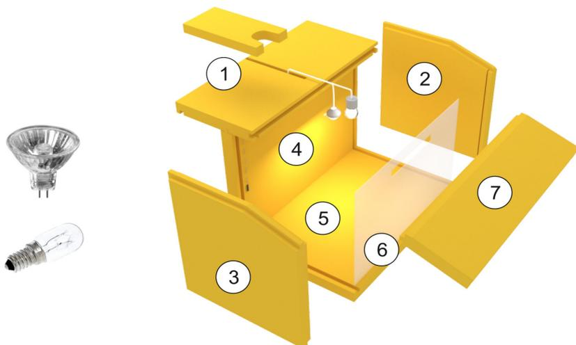
1, 4 – стенки в сборе с электрикой и датчиком
